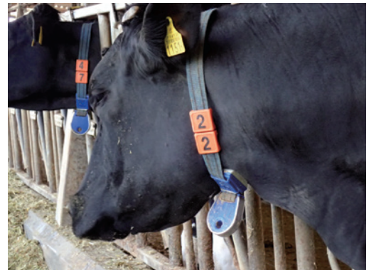
（写真1）首輪に装備した個体識別タグ、および活動量計を組み込んだセンサー。
