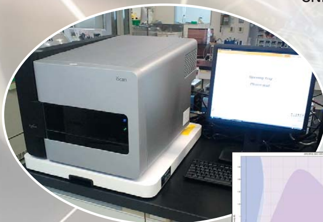
チップに乗せたDNA情報を 読み取る機械 (iScan)
