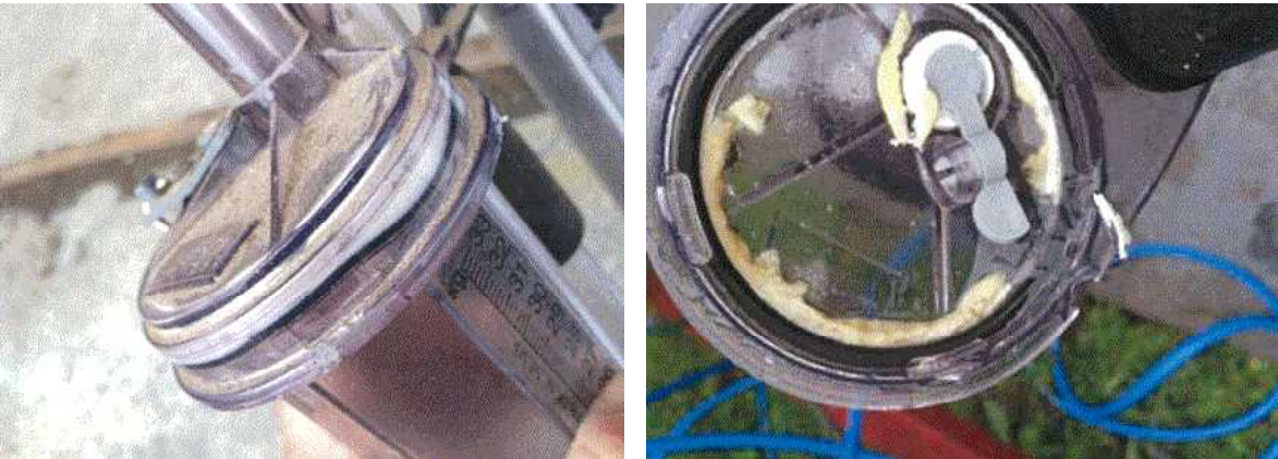
図1 ほこりにまみれた乳量計とチーズ状の内部の汚れ
