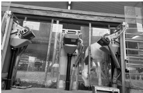
元パーラースペースに設置された搾乳ロボット
